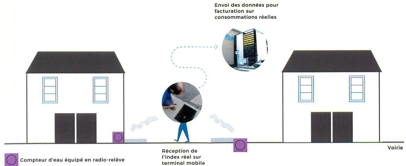
Le module de radio-relève s'adapte sur le compteur d'eau. Lors de son passage à proximité du compteur, l'agent d'exploitation récupère l'index sur son terminal mobile, sans avoir besoin d'accéder directement au compteur. Les données sont ensuite transférées dans le logiciel de suivi des contrats pour permettre la facturation.
